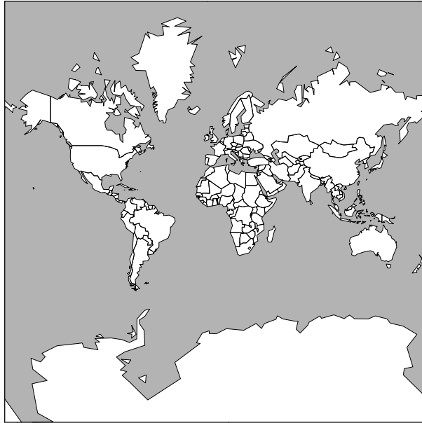
Fig. 1.10. La carte du monde avec la projection de Mercator. Comme la carte a une hauteur infinie, on n'a représenté que la région située entre les latitudes 85^\circ\text{S} et 85^\circ\text{N} .
